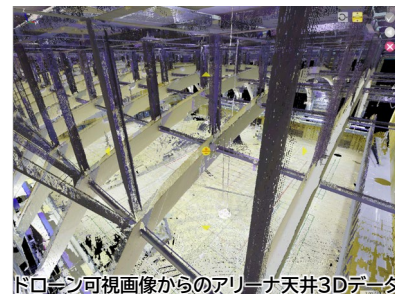
ドローン可視画像からのアリーナ天井3Dデータ
